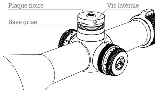
En ajustant le fusil à 100 yards, le tireur peut calculer le nombre de clics d'ajustement qui sont nécessaires pour des distances différentes, ou pour des conditions de vent. Après le tir, le tireur peut rapidement tourner le bouton d'élévation dans la direction des aiguilles d'une montre
